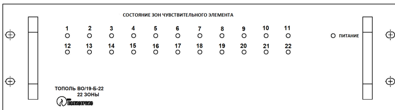
Рисунок 2 - Расположение единичных индикаторов на лицевой панели БОС
